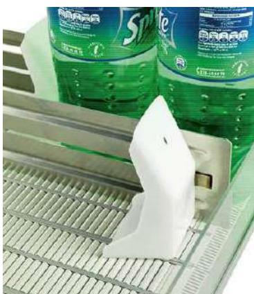
Empujador con separador incluido para colocar en Roller Track™.
