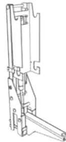
Soporte para colocar los dispensadores en barra de fuerza con brazo oscilante. Hay dos medidas: SD-100MM SD-150MM Material Estándar: metal
